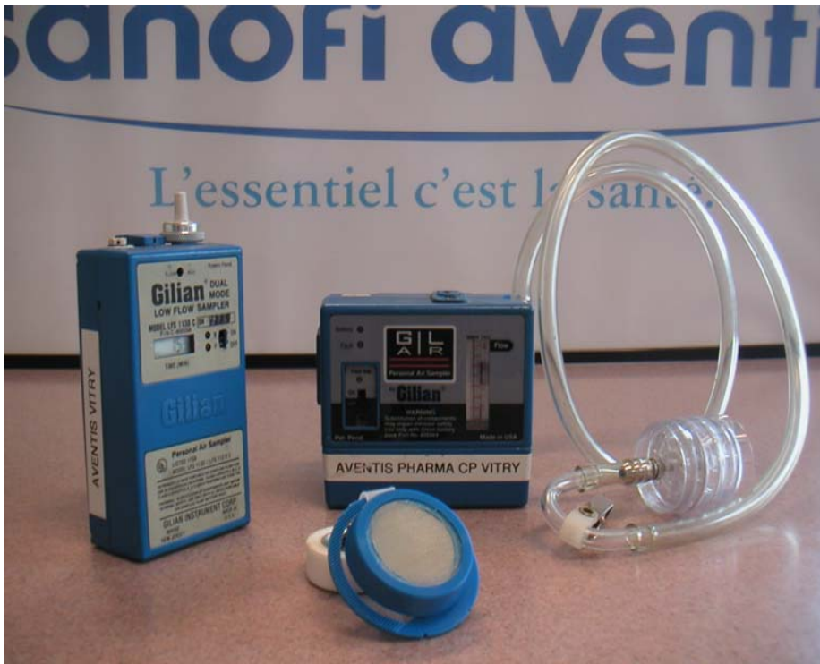
Pompes gaz et poussières Gillian et badges 3M/Arelco
